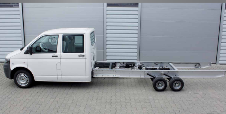
FGS chassistechiek® Weinig eigengewicht, veel netto laadvermogen door de uitgekiende FGS-profielen
