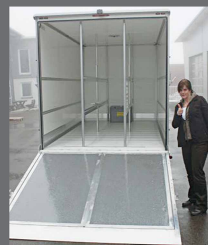
Overrijdbare, veerontlaste laadklep, ook als vast portaal met dubbele deuren leverbaar
