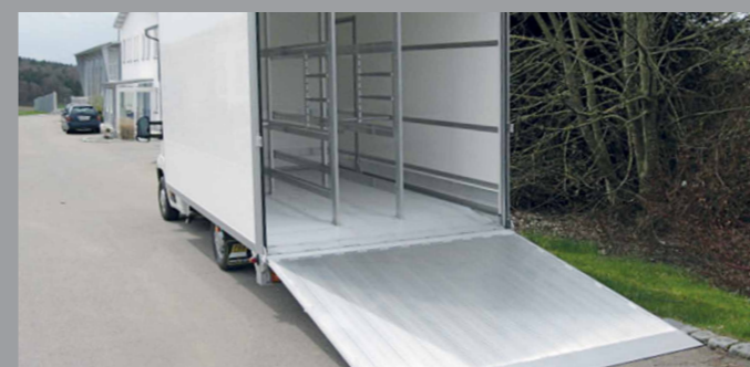
Overrijdbare, veerontlaste laadklep, ook als vast portaal met dubbele deuren leverbaar
